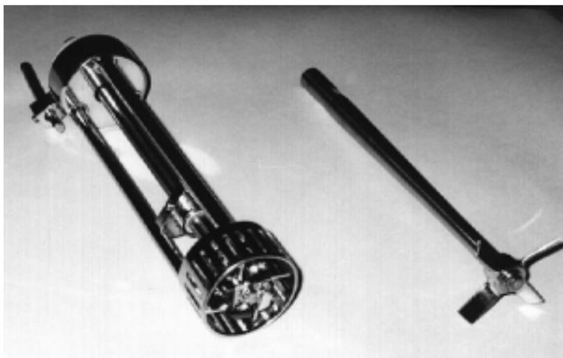
Figura 4 – O homogeneizador, a esquerda, e a turbina, a direita.
